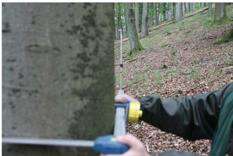
Abb. 5: Messung des BHD in 1,3 m Höhe. Die Messschiene der Kluppe zeigt exakt auf den Mittelpunkt. Im geneigten Gelände befindet sich die Messstelle in der bergseitig gemessenen Höhe von 1,3 m.
