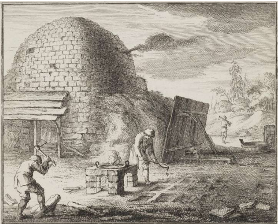
Der 1765 angefertigte Kupferstich „Der Teerbrenner“ von Johann Wilhelm Meil (1733-1805) zeigt einen typischen Teerofen, wie er wahrscheinlich auch im Raum Wildeck üblich war. Die gemauerten, doppelwandigen Öfen wurden meist mit harzreichem Nadelholz (z. B. Kiefernstubben) befüllt. Der Teer, der in Hessen auch Pech oder Schmer genannt wurde, floss in ein vor dem Ofen stehendes Auffanggefäß. Teer kann durch Verkochen in einem weiteren Arbeitsgang zu wirklichem Pech verarbeitet werden.
