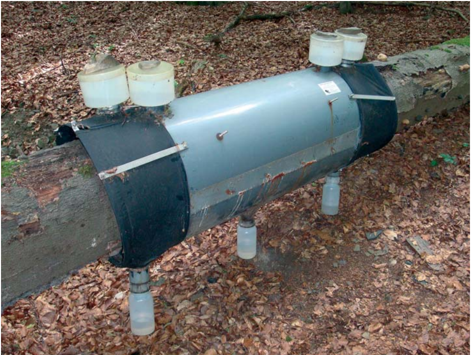
Ein sogenannter Stammeklektor an einem freiliegendem Stamm. Mit diesem Fallentyp fängt man Tiere, die am Stamm entlang laufen oder aus der Rinde schlüpfen.
