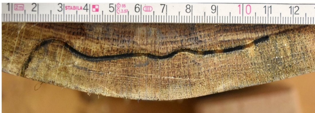
Bohrgang des Eichenkernkäfers. Eine Erweiterung des Brutbildes in das Kernholz hinein erfolgt meist erst im folgenden Frühjahr.
