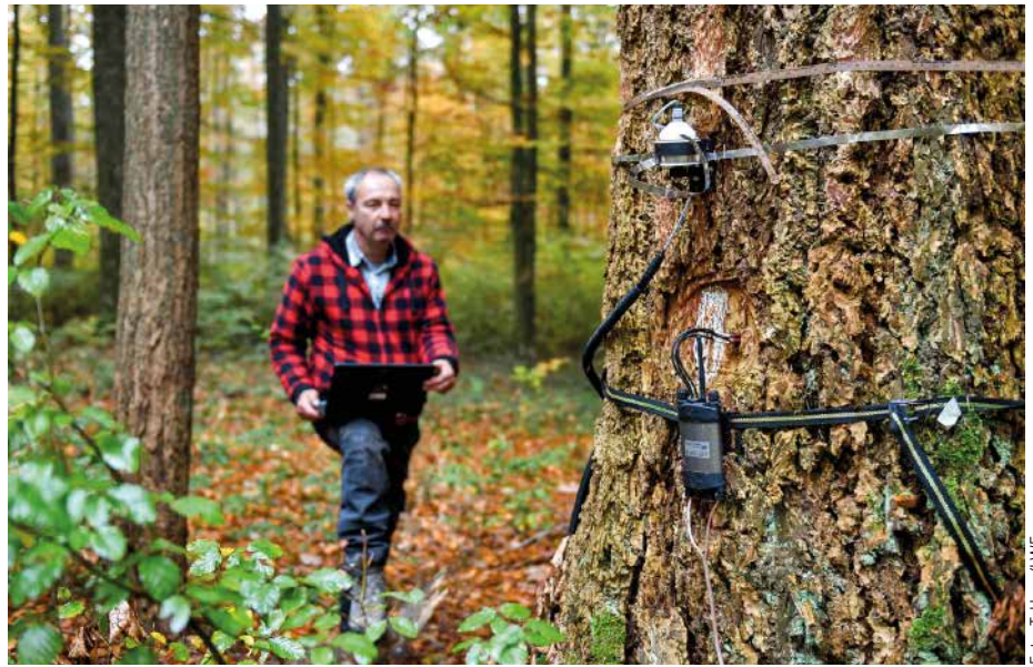
Abb. 3: Ein Mitarbeiter der LWF liest Daten zum Saftfluss und zum Radialwachstum an einer Douglasie auf einer Level-II-Fläche in Bayern aus.
