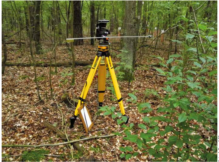
Abb. 2: Erfassung der Kronenraumstruktur mit hemisphärischer Photogrammetrie
