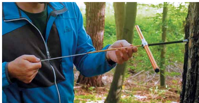
Probennahme eines Bohrkerns mit Hilfe eines Zuwachsbohrers
