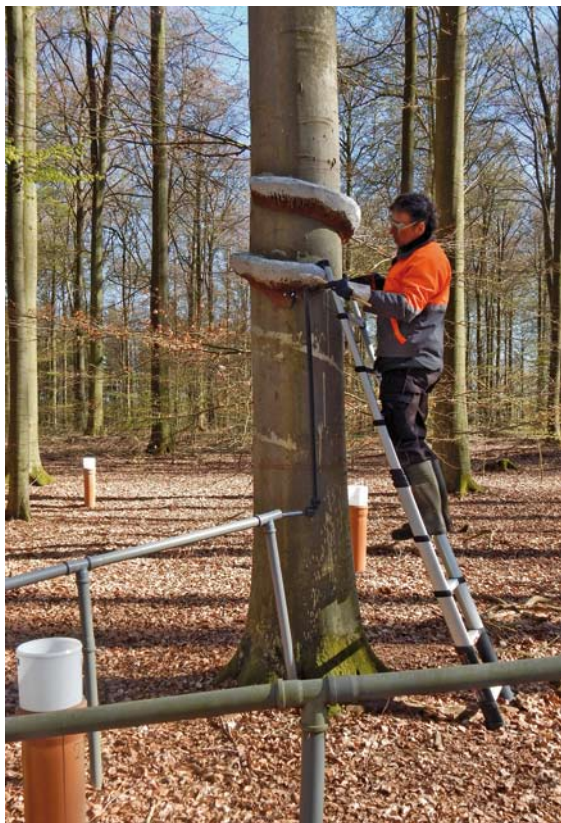
Intensiv-Monitoringfläche Bornhöved: Wartung der Stammablaufmessung Foto: O. Schwerdtfeger
