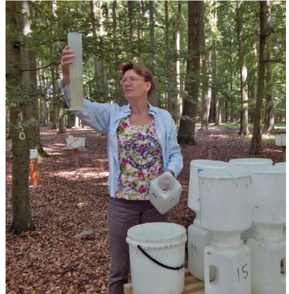
Intensiv-Monitoringfläche Bornhöved: Erfassung der Niederschlagsmenge Foto: O. Schwerdtfeger
